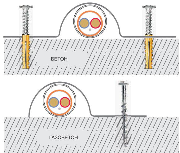
Для крепления ОКЛ с прокладкой кабелей в кабель каналах непосредственно к поверхности стен, потолков и стальных конструкций используются универсальные металлические дюбели вместе с стальными оцинкованными саморезами, дюбель-гвозди металлические, быстромонтажные металлические анкеры, перфорированная лента, хомуты металлические и хомуты металлические для скрепления короба (рисунок В).
