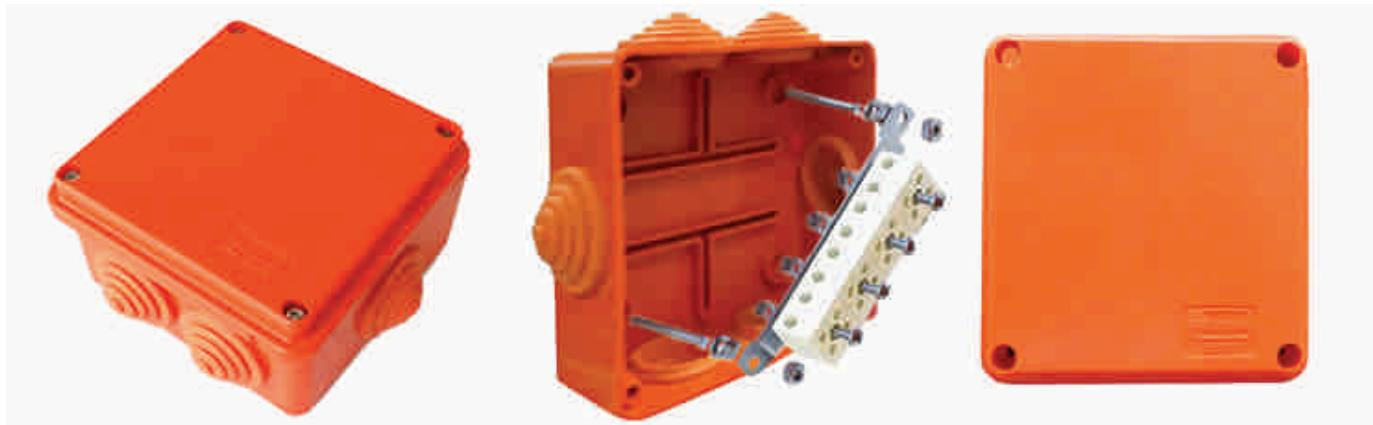
Огнестойкие коробки гарантировано обеспечивают надежное соединение, и работоспособность кабельной линии при температурах более 1000°C. Индексы Е60 и Е90 означают время сохранения работоспособности огнестойкой кабельной линии при пожаре, не менее 60 и 90 минут, соответственно.
