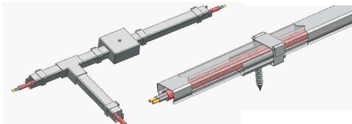
Вариант исполнения ОКЛ «АвангардЛайн» с использованием труб гибких гофрированных с параллельной прокладкой двух линий под один саморез двумя скобами и коробок монтажных огнестойких различного производства.
