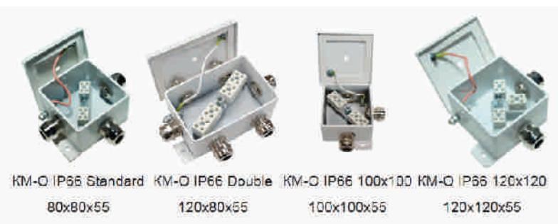
Корпус коробки целиком изготовлен из стали 2,5-3 мм. Имеет двойную защиту от коррозии. Крышка прижимается к корпусу через силиконовую прокладку. Винт крепления крышки снабжен уплотняющей тарельчатой шайбой с фторопластовым покрытием. Внутри корпуса коробки установлены керамические клеммные колодки, обеспечивающие соединение "под винт", и клемма заземления «РЕ».
